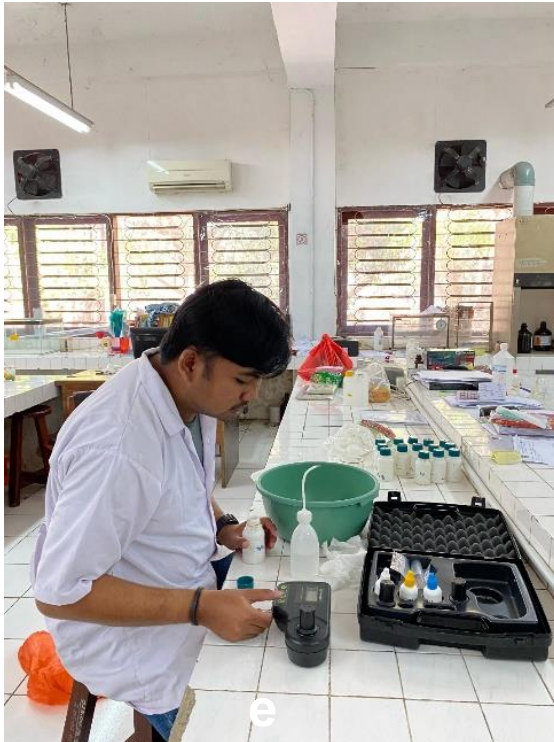
(a).Pengukuran salinitas; (b). Pengayakan sampel sedimen; (c). Penumbukan sampel sedimen setelah oven; (d). Proses penimbangan sampel sedimen; (e). Pengukuran nilai kekeruhan
