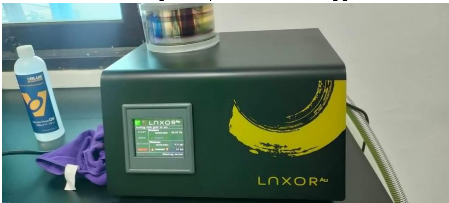
Coating (Luxor AU/Pd SEM Coater, Germany)
