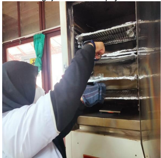
Uji kadar air menggunakan oven
