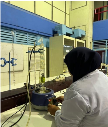
Alat Soxhletasi untuk penentuan kadar lemak
