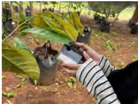
Gambar Lampiran 4. Pengamatan menggunakan LUX Meter dan C1-710/720 Miniature Leaf Spectrometer
