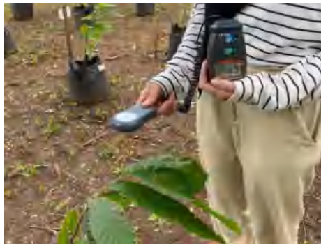
Gambar Lampiran 4. Pengamatan menggunakan LUX Meter dan C1-710/720 Miniature Leaf Spectrometer
