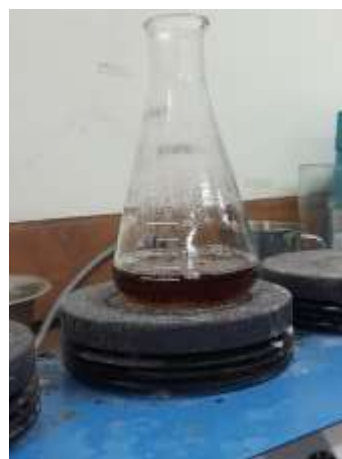
Penambahan \text{H}_2\text{SO}_4 30 % lalu volume sampel direduksi dan penambahan \text{NaOH} 10 % dan kloroform pada corong pisah
