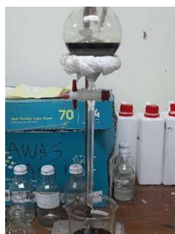
Penambahan \text{H}_2\text{SO}_4 30 % lalu volume sampel direduksi dan penambahan \text{NaOH} 10 % dan kloroform pada corong pisah
