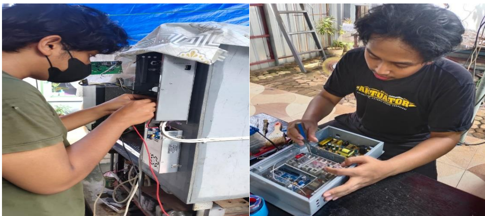
Perakitan sistem kontrol pada biofermentor
