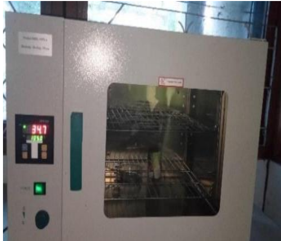
d. Mengoven sampel tanah selama 24 jam menggunakan suhu 105 °C
