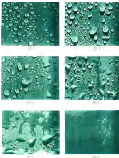
Gambar 3 Karakteristik hidrofobik pada isolator polimer
