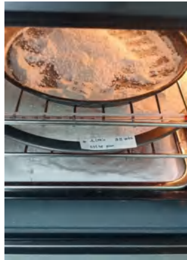
Curing filler selama 24 jam
