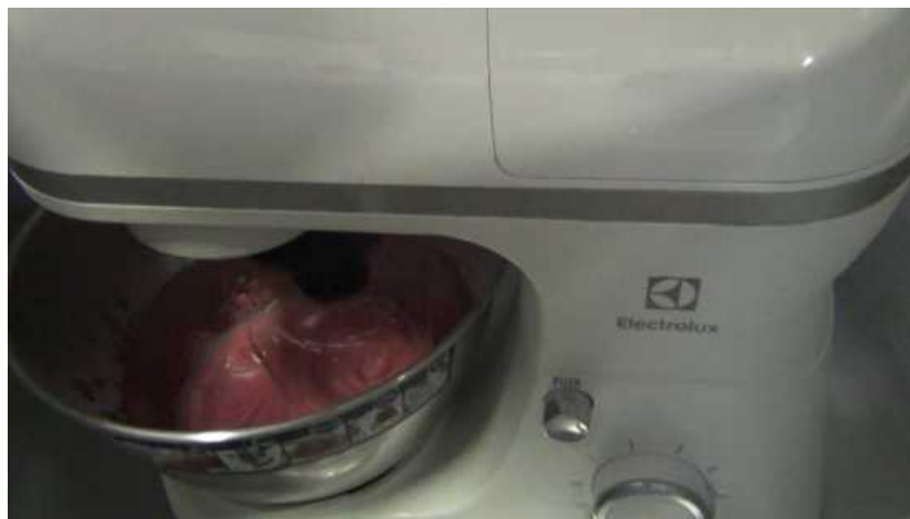
Proses pencampuran silicone rubber, filler dan hardener .
