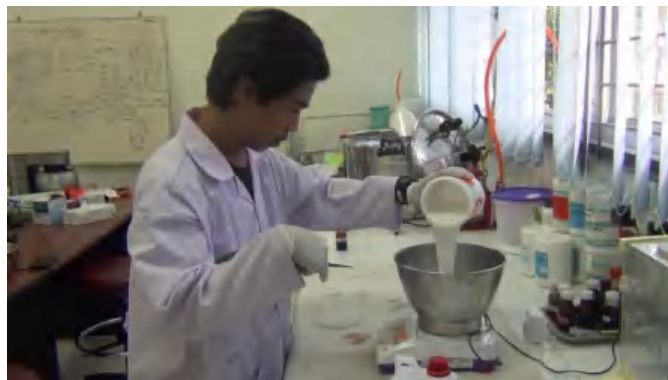
RTV 683 Silicone rubber dimasukkan kedalam wadah pencampuran
