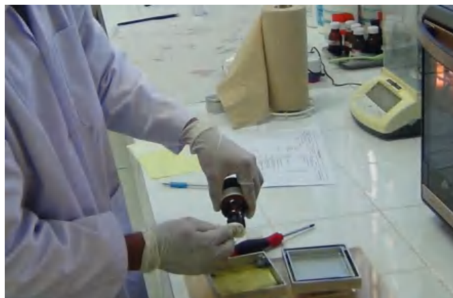
Proses pengolesan minyak silikon atau silicone grease pada cetakan
