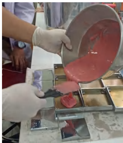
Proses mencetak sampel yang dituang pada cetakan 7x7cm
