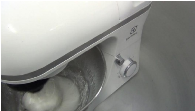
Proses pencampuran silicone rubber dan filler
