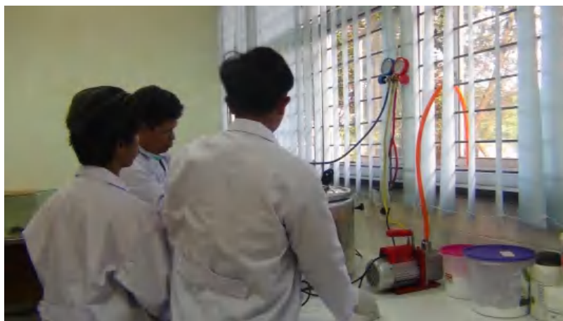
Proses vakum juga berlangsung pada saat pencampuran dilakukan
