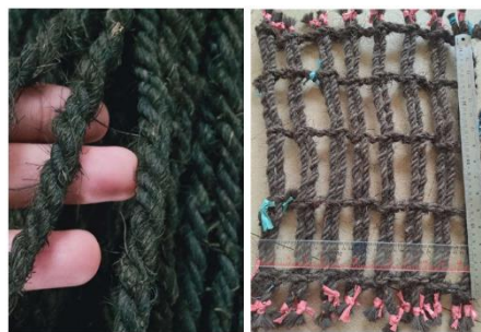
Gambar 4 Serat Ijuk berdiameter 0.40-0.50 mm
