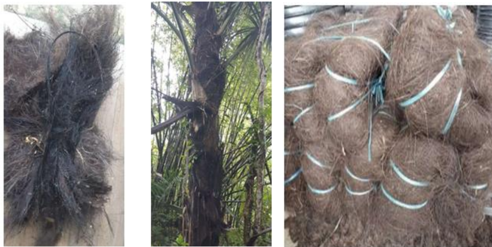
Gambar 5 Penggunaan Ijuk sebagai Geogrid
