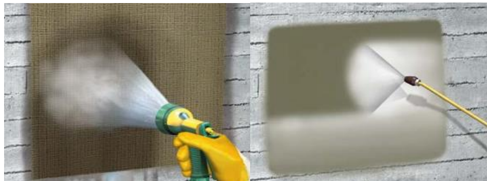
Gambar 15. Curing pada beton
