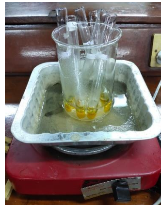
Proses pemanasan menggunakan Water Bath
