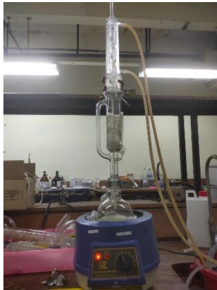
Rangkaian alat soxhletasi
