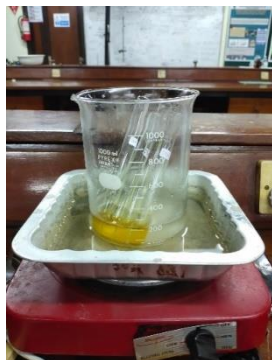
Pemanasan menggunakan water bath
