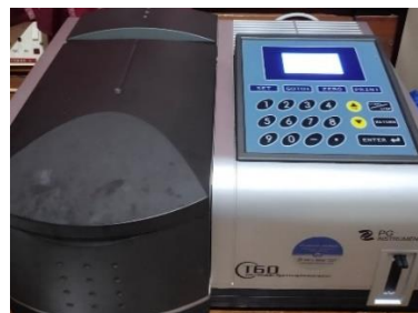
Pengukuran absorbansi sampel
