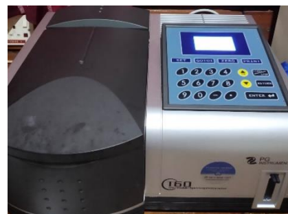
Pengukuran panjang gelombang dan absorbansi
