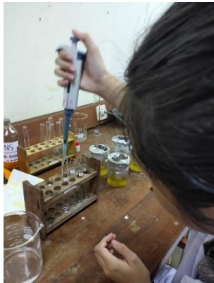
Penambahan \text{KHSO}_4 ke dalam sampel
