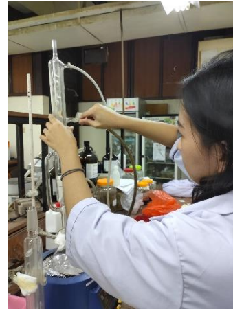
Proses ekstraksi metode soxhlet
