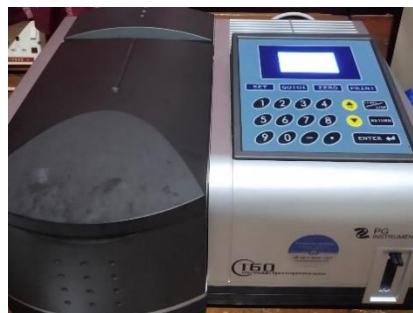
Pengukuran absorbansi sampel
