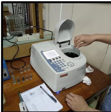
Pengukuran Nilai Absorban Larutan Kurva Standar dan Kadar Amonia Kultur Bakteri Menggunakan Spektrofotometer UV-Vis
