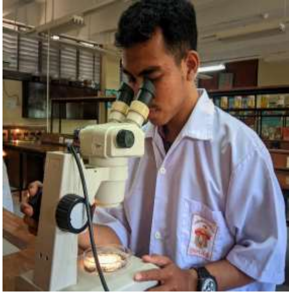
Gambar 17. Proses pengamatan morfologi foraminifera pada sampel sedimen dasar perairan.
