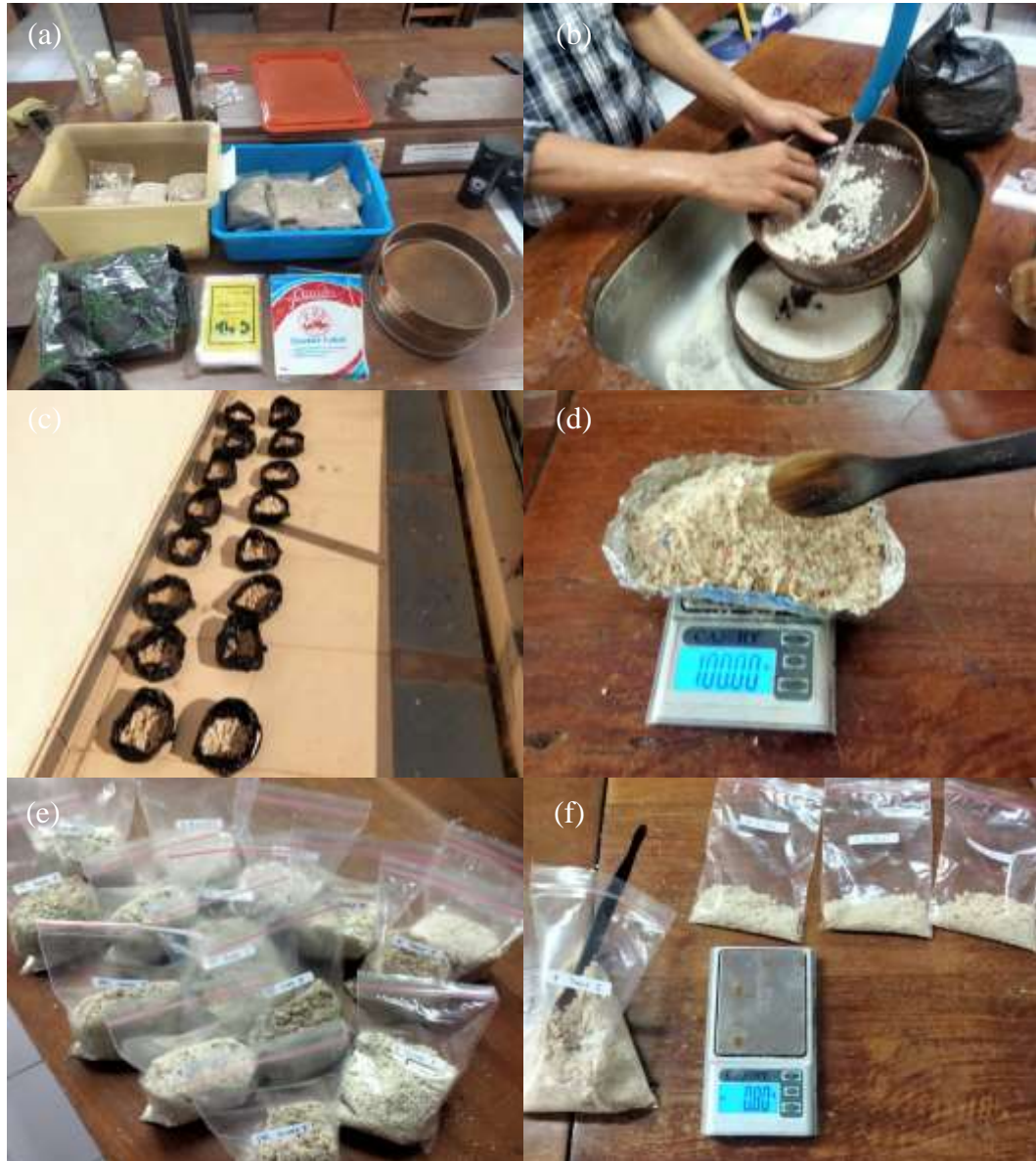
Gambar 16. Proses preparasi sampel sedimen dasar perairan (alat dan bahan (a), pencucian dan penyaringan sampel sedimen (b), penjemuran sampel sedimen (c), penimbangan sampel sedimen (d), sampel sedimen 100 gr (e), 10% sampel sedimen untuk sub sampel (e).
