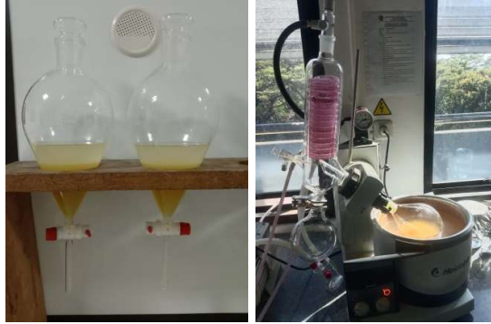
Gambar 9. Proses ekstraksi hasil fermentasi isolat FJM -0.2-2
