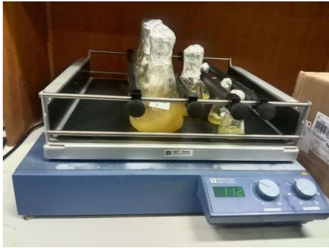
Gambar 4. Proses fermentasi pada inkubator shaker
