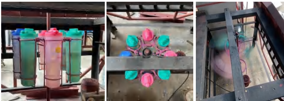
Gambar 32. Proses pemisahan minyak, air, dan blondo menggunakan mesin sentrifuge .
