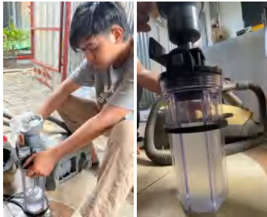
Gambar 34. Proses penyaringan menggunakan vacum filter .
