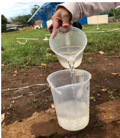
Gambar 25. Pengukuran debit yang tertampung dalam wadah.
