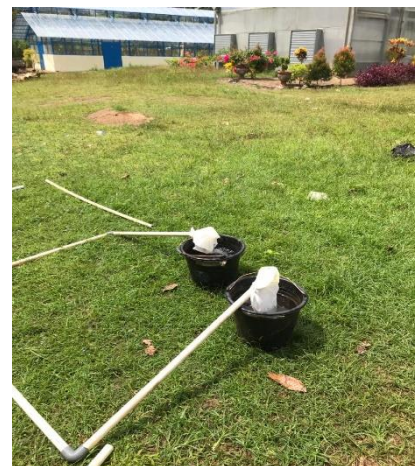
Gambar 25. Pengukuran debit yang tertampung dalam wadah.
