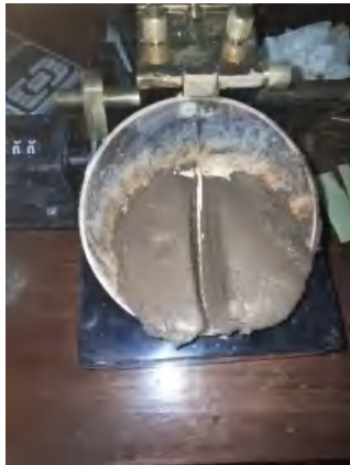
Gambar 1. Pengamatan batas cair sebelum ketukan
