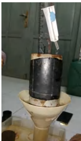
Gambar 6. Pengamatan nilai cole sebelum di oven
