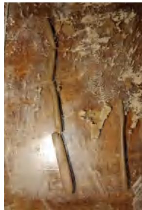
Gambar 3. Pengamatan batas plastis sebelum dan sesudah patah
