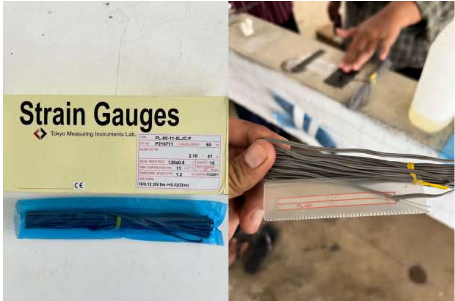
Pemasangan Strain Gauges Beton
