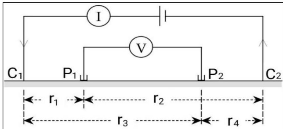
Gambar 2.6 Susunan Dua Elektroda Arus ( $C_1$  dan  $C_2$ ) dan Potensial ( $P_1$  dan  $P_2$ ) di Permukaan Bumi (Lowrie, 2007).
