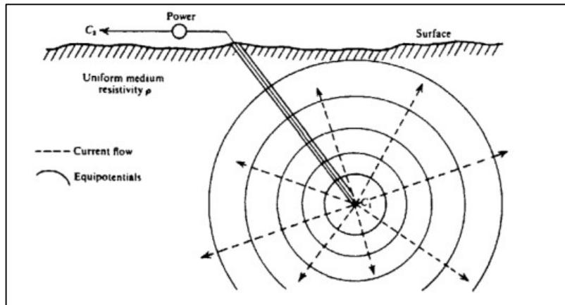
Gambar 2.4 Sumber Arus Tunggal di Dalam Bumi (Telford et al., 1990)
