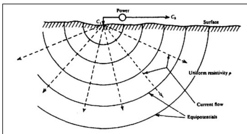
Gambar 2.5 Sumber Arus Tunggal di Permukaan Bumi (Telford et al., 1990)
