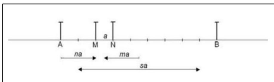
Gambar 2.7 Sketsa dari konfigurasi *gradient*
