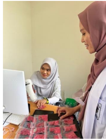
Pengujian warna menggunakan instrumen colorimeter
