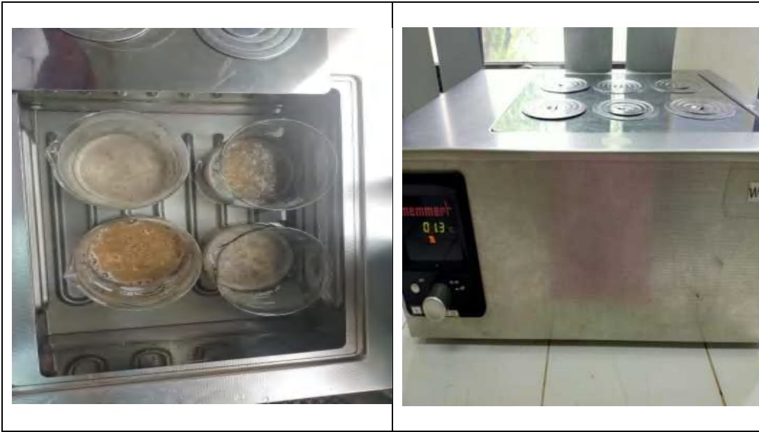
Proses limbah algae Kappaphycus alvarezii dipanaskan dengan menggunakan water bath pada suhu 100°C selama 2 jam
