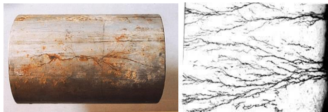
Gambar 6. Korosi Tegangan (Utomo, 2009)
