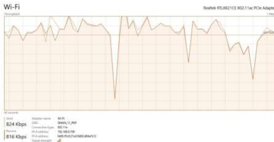
Lampiran 65 Throughput WiFi pada AP SMAN_11_PKP setelah ICMP flood pengujian 5
