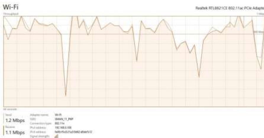
Lampiran 66 Throughput WiFi pada AP SMAN_11_PKP setelah SYN flood pengujian 2
