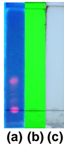
Gambar 6. Profil KLT fraksi 1-18 di bawah lampu UV long wave (a), di bawah lampu short wave (b), dan dipanaskan setelah disemprot \text{CeSO}_4 (c)
