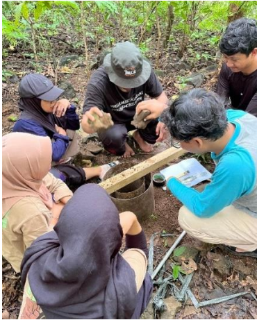
Pemasangan Double Ring Infiltrometer
