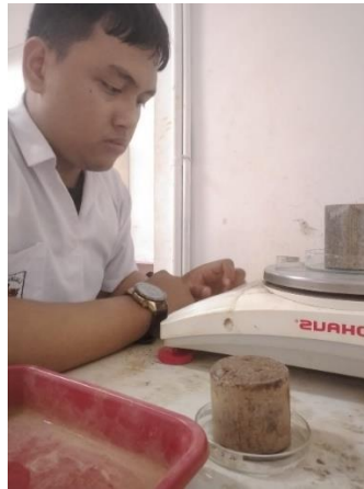
Proses menimbang sampel tanah utuh pengukuran bulk density
