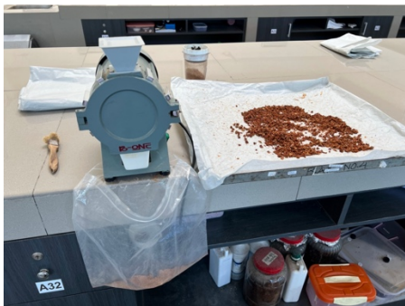
Penggilingan biji pinang dengan grinder
