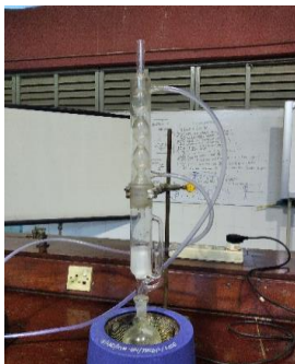
Proses soxhletasi (Analisis kadar lemak)
