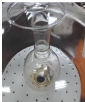
Pengukuran bobot tetap metode soxhlet
