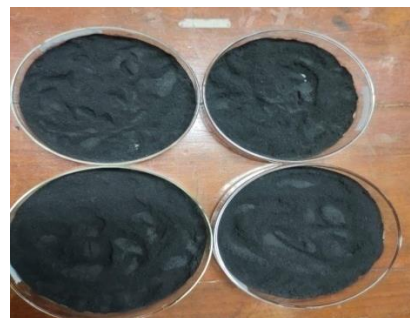
Karbon Aktif Setelah Pengeringan pada suhu 110 ^{\circ}C selama 3 jam
