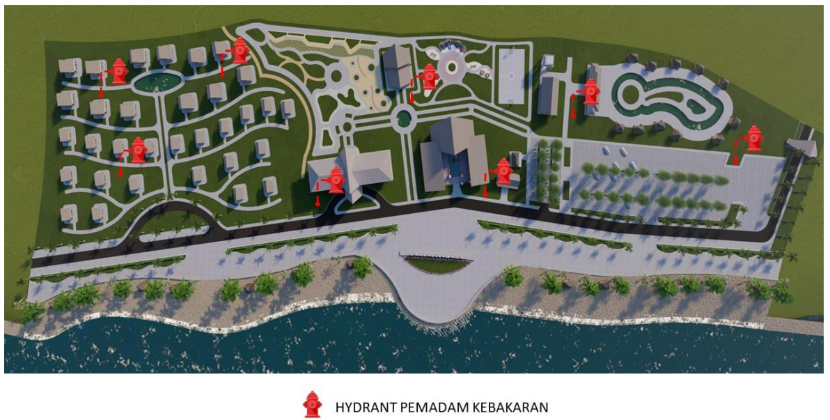
Gambar 16. Sistem Pemadam Kebakaran
