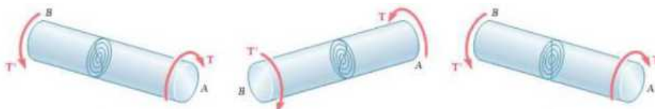
Gambar 8. Potensial konsentrasi tegangan yang terbentuk akibat beban puntir
