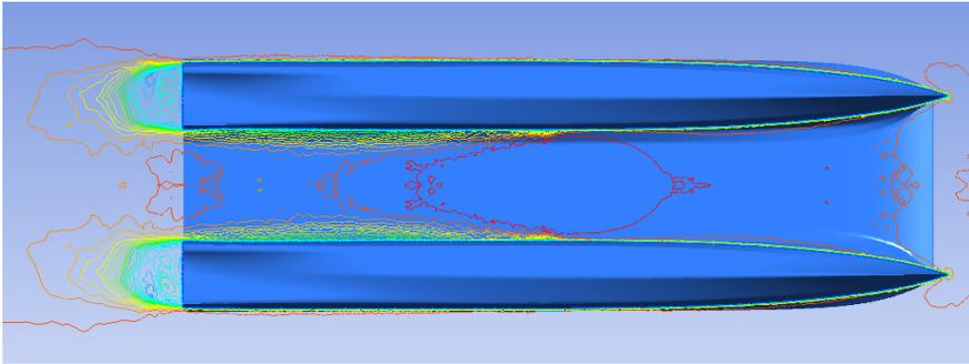
4. Visualisasi pola aliran pada variasi jarak lambung 3
