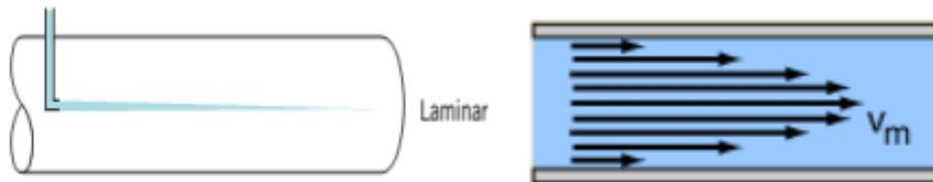
**Gambar 11.** Aliran Laminar
