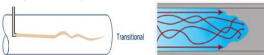
**Gambar 12.** Aliran Transisi
