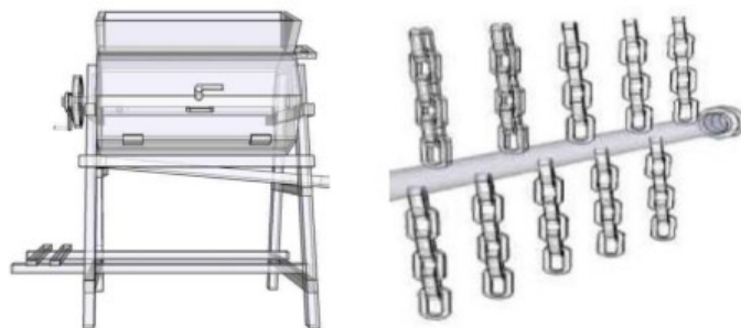
Gambar 8 Mesin pemipil jagung non daun mata pemental rantai
