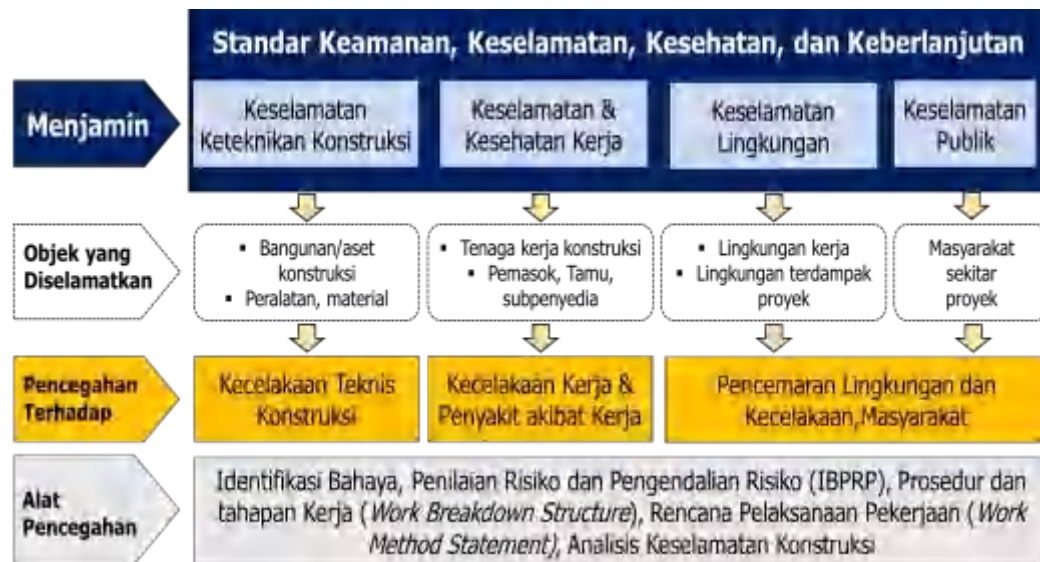
Gambar 2.13 Standar Keselamatan Konstruksi (Permen PUPR No. 10 Tahun 2021)
