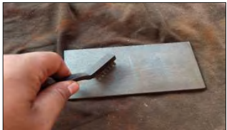
Membersihkan benda uji (ASTM G1)
