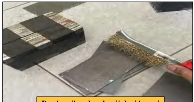
Pembersihan benda uji dari korosi dengan sikat halus
