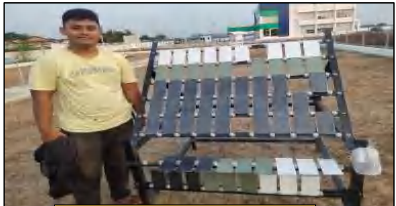
Pemaparan benda uji dan pemasangan data logger
