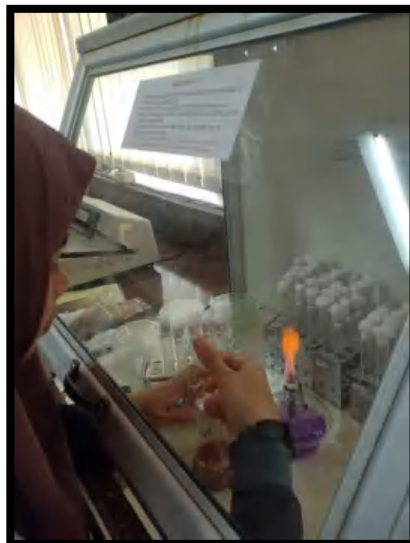
Gambar 21. Proses Pengenceran Sampel Tanah
