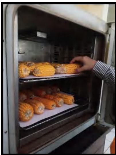
Gambar 20. Pengeringan Buah Jagung dengan Menggunakan Oven
