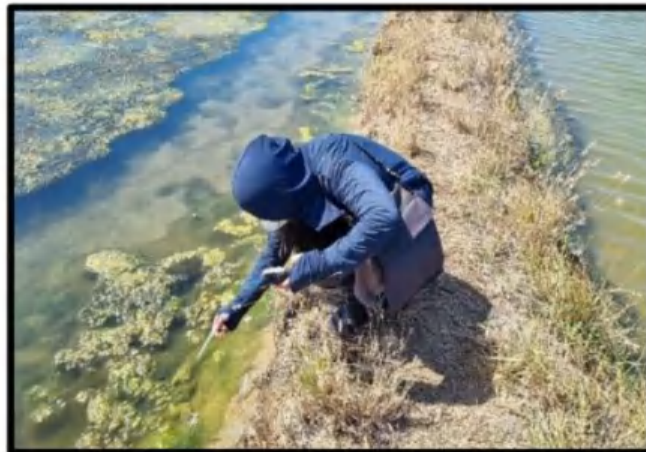
Gambar 19. Pengukuran kadar salinitas air menggunakan salinity refractometer
