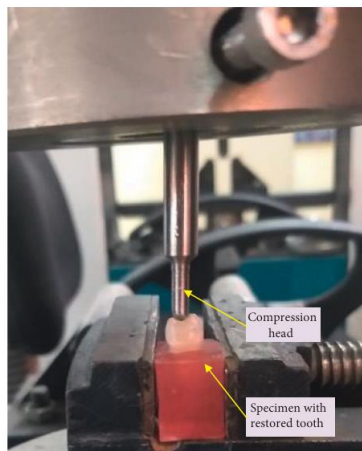
Gambar 1.6 Uji ketahanan fraktur dengan Universal Testing Machine (UTM)
