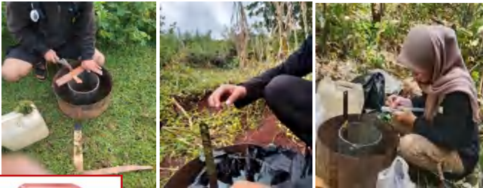
2. Pemasangan dan pengukuran laju infiltrasi menggunakan double ring infiltrometer
