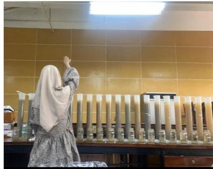
**Gambar Lampiran 2.** Pengukuran tekstur metode hidrometer
