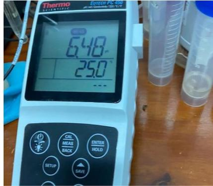
**Gambar Lampiran 1.** Pengukuran pH tanah dengan pH meter
