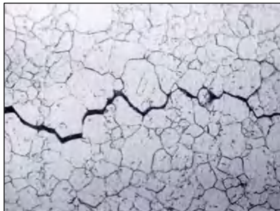
Gambar 2. 12 Korosi Tekan Retak
