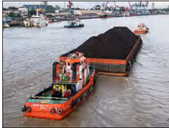
Gambar 2. 16 Tongkang pengangkut batu bara
