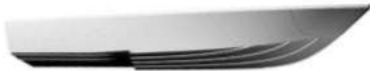
Gambar 8 Kapal dengan lambung bertangga
