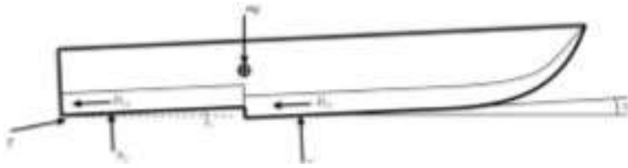
Gambar 7 Visualisasi kapal dengan stepped
