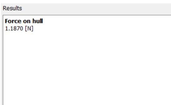
7. Model kapal tanpa menggunakan *vortex generator* Kecepatan 1,513 dengan trim 1°
