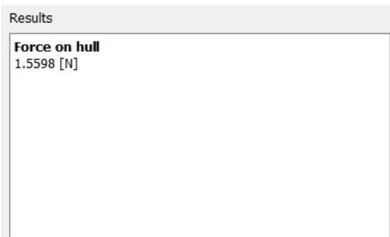
6. Model kapal tanpa menggunakan *vortex generator* kecepatan 2,016 m/s dengan trim 2°
