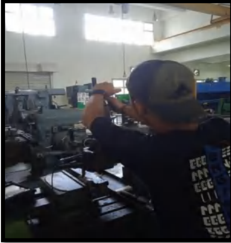
Lampiran 1. Proses penyekrapan dan Pengambilan Data Getaran dengan VIBExper II
