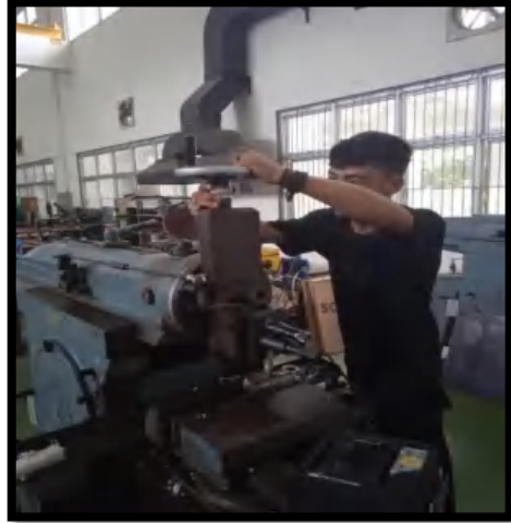
Lampiran 1. Proses penyekrapan dan Pengambilan Data Getaran dengan VIBExper II
