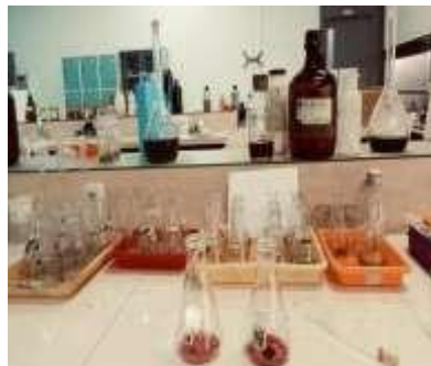
Gambar Lampiran 4. Analisis Nitrogen dengan metode Kjeldahl
