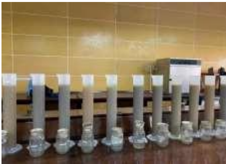
Gambar Lampiran 2. Pengukuran tekstur metode hidrometer
