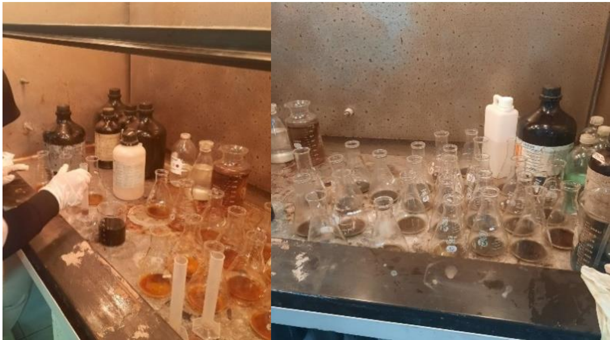
Proses pengukuran C-organik menggunakan metode walkley and black
