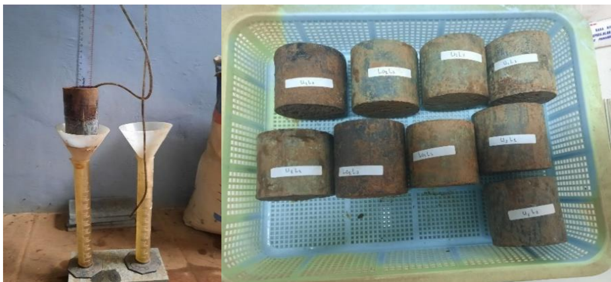
Proses pengukuran permeabilitas tanah menggunakan metode permeameter
