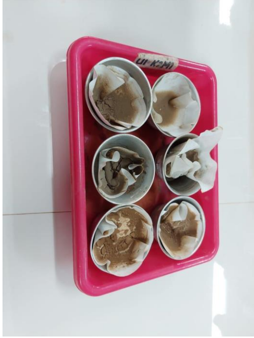
Lampiran 10 Sampel dioven setelah dilakukan penyaringan
