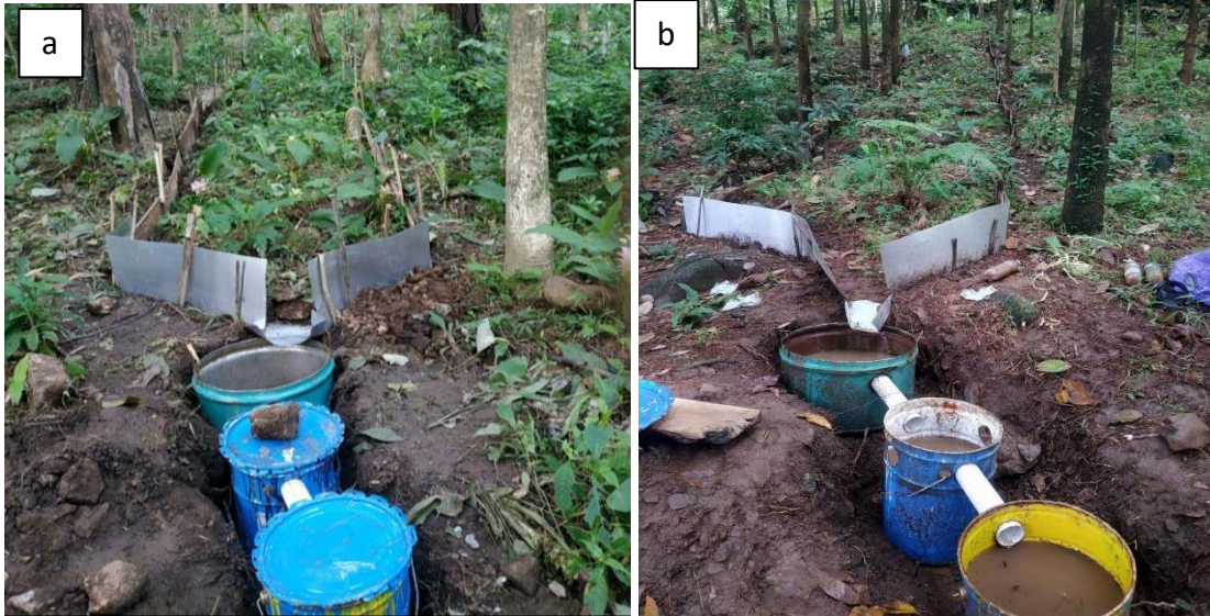
Lampiran 6 Penampang plot erosi (a. plot erosi pada HTI Agroforestri, b. plot erosi pada HTI Monokultur)
