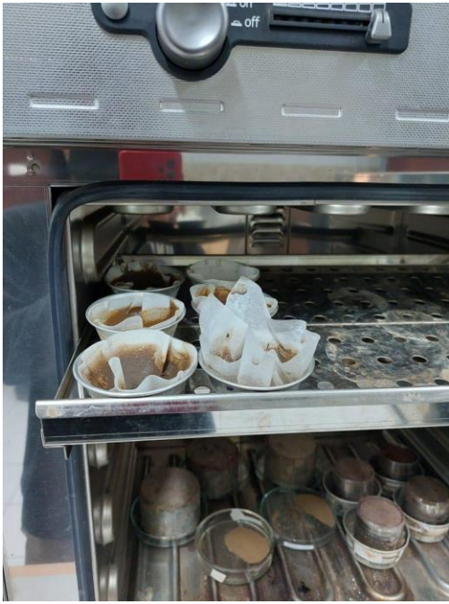
Lampiran 10 Sampel dioven setelah dilakukan penyaringan
