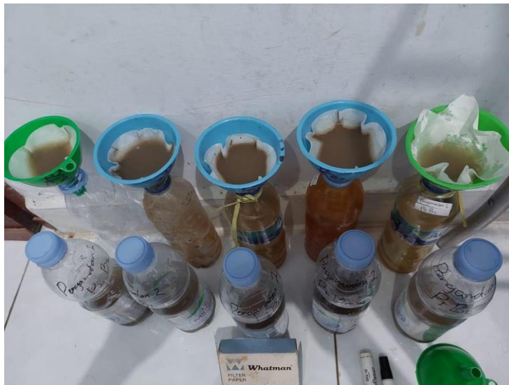
Lampiran 9 Penyaringan sedimen tanah pada sampel yang telah diendapkan
