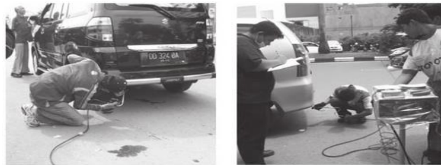
Gambar 1. Pengukuran Emisi Kendaraan Stasioner Sumber : Aly, 2015
