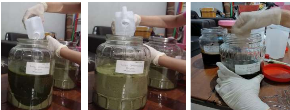
Lampiran Gambar 6. Maserasi selama 3 hari bubuk bunga jantung pisang dan daun tithonia yang telah diblender halus, dengan pelarut methanol dan n-heksan.
